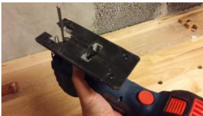
FLEKSIBEL: Maskinen kan brukes begge veier, og sage fra undersiden eller oversiden av materialet. (Foto: BRYNJULF BLIX)
