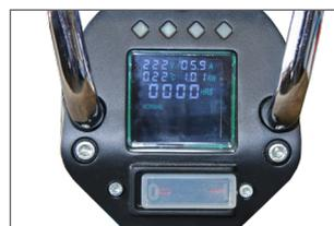
Affichage en temps réel de l'ampérage, puissance de sortie, tension et température
